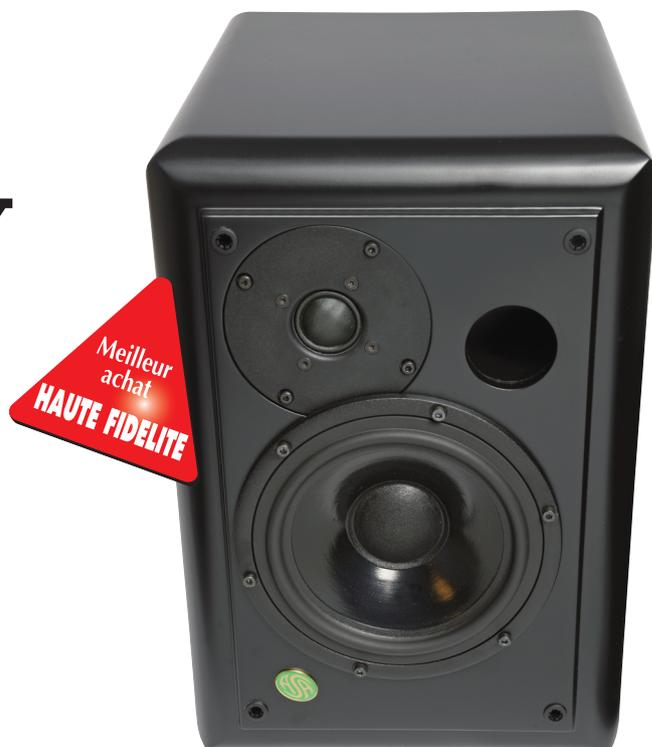
rie de 28 mm d'épaisseur, le constructeur est parvenu à loger un boomer de 18 cm de diamètre décompressé par un évent situé en façade, et un tweeter de 2,54 cm sur le baffle rapporté. Les filtres passifs sont mesurés et triés par paires, imprégnés dans la résine pour éviter les vibrations, puis mesurés à nouveau.
